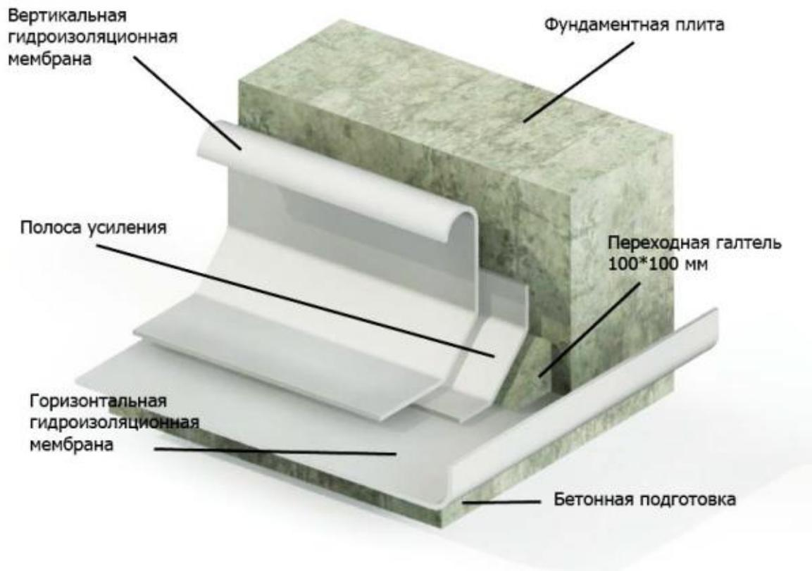
Рис.1 Стыковка горизонтальных и вертикальных частей гидроизоляционной мембраны.
