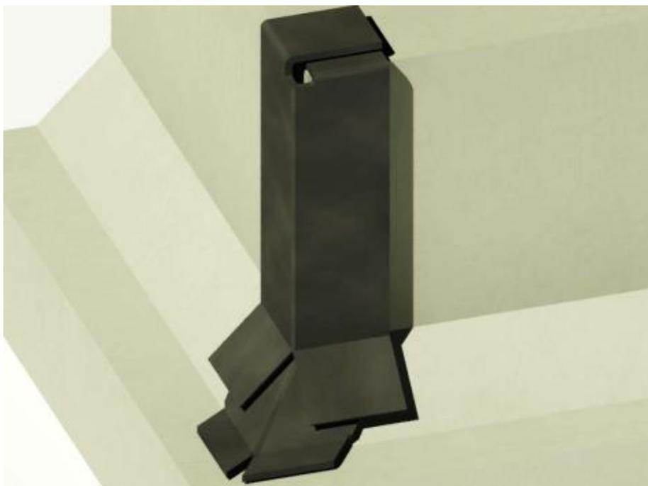
Рис.9 Усиление в вертикальной части наружного угла.
