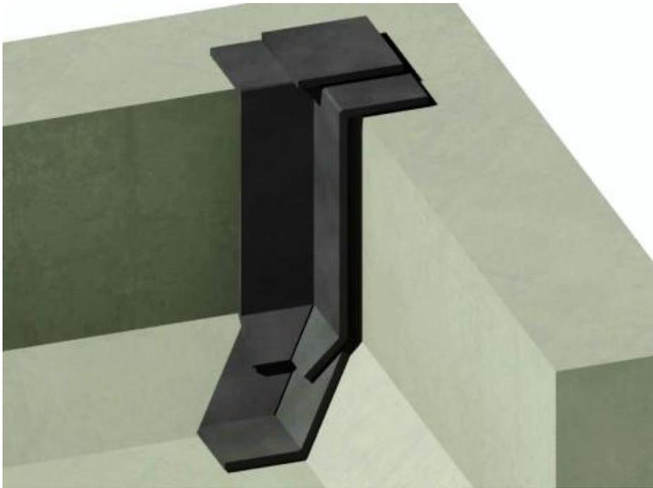
Рис.11 Усиление внутреннего угла.
