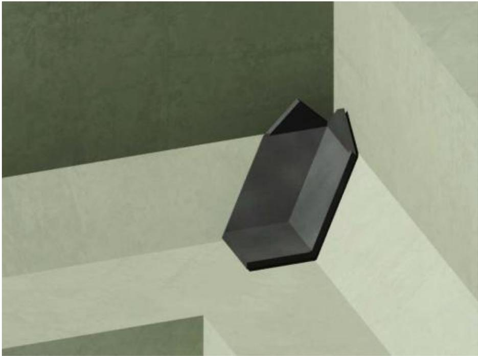
Рис.10 Усиление внутреннего угла в зоне галтели.
