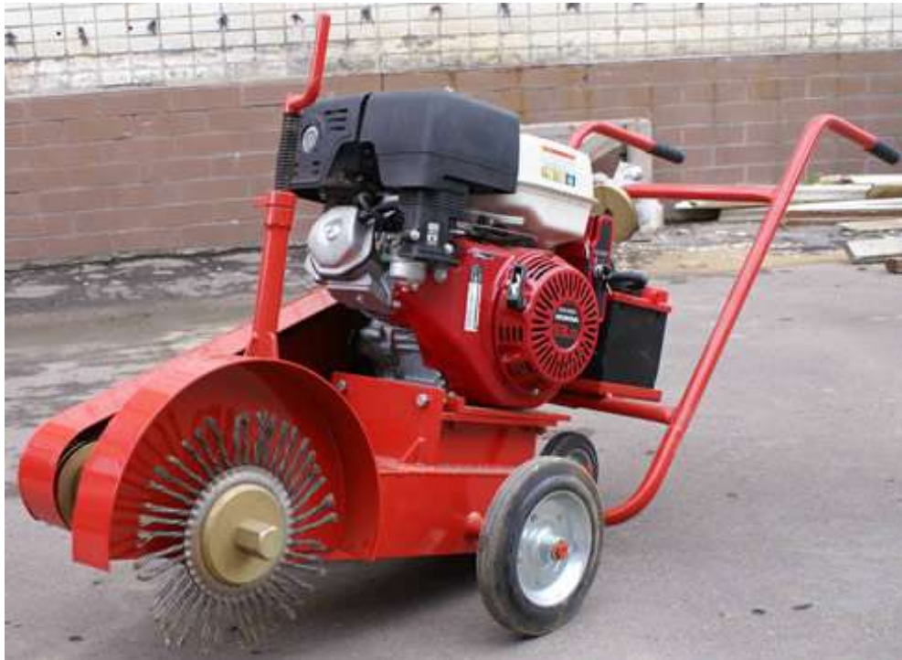
Рис.4 Машина для расчистки швов и трещин.
